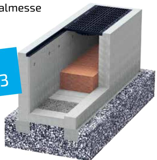
Versickerung mit technischem Filter von Oberflächenwasser
